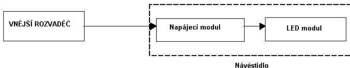
Obr. 3 Schématický náčrt hlavních částí návěstidla
